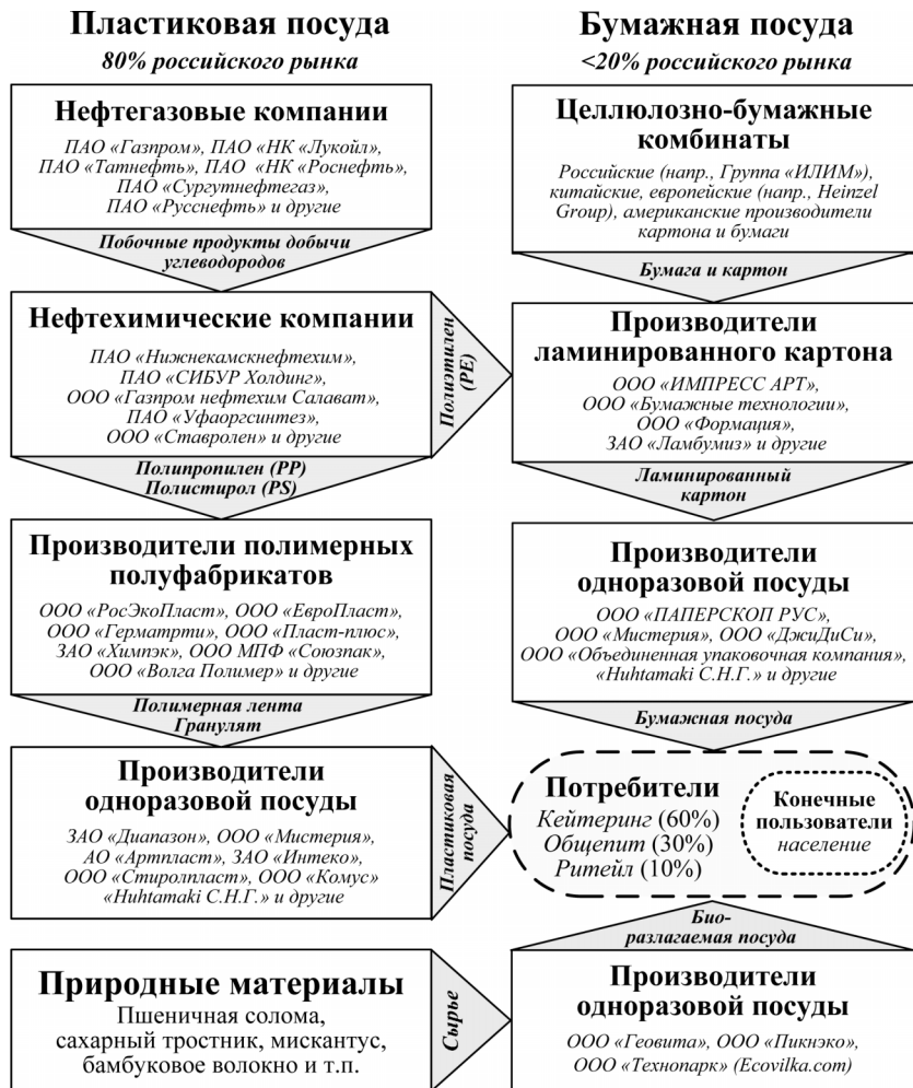
Рис. 1. Технологическая цепь производства одноразовой посуды в России
