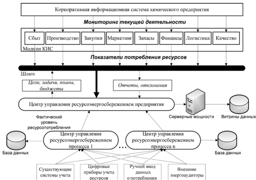
Рис. 1. Методика организации ресурсоэнергоконтроллинга на химических предприятиях с использованием инструментальных корпоративных информационных систем
